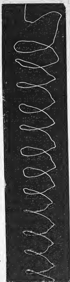
Fig. 100. — Ellipse tracée par une verge de Wheatstone accordée à l'unisson, lorsqu'elle écrit sur un cylindre tournant.
